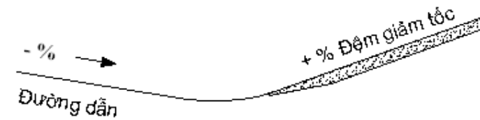
a) Đường cứu nạn bố trí đệm giảm tốc dốc lên
