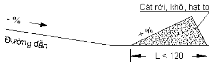
d) Đường cứu nạn sử dụng ụ cát
